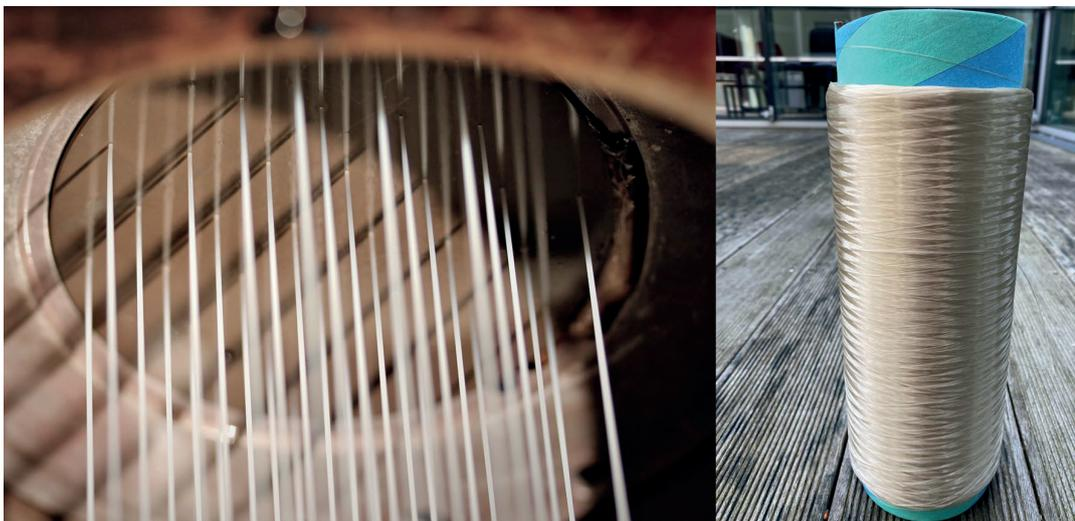
Hochleistungspolymeren wie PEEK lassen sich ausspinnen (links) und anschließend zu Garnen und Textilien (rechts) verarbeiten. Durch Blends mit technischen Kunststoffen ist dabei eine deutliche Kostenreduktion möglich © ITA
